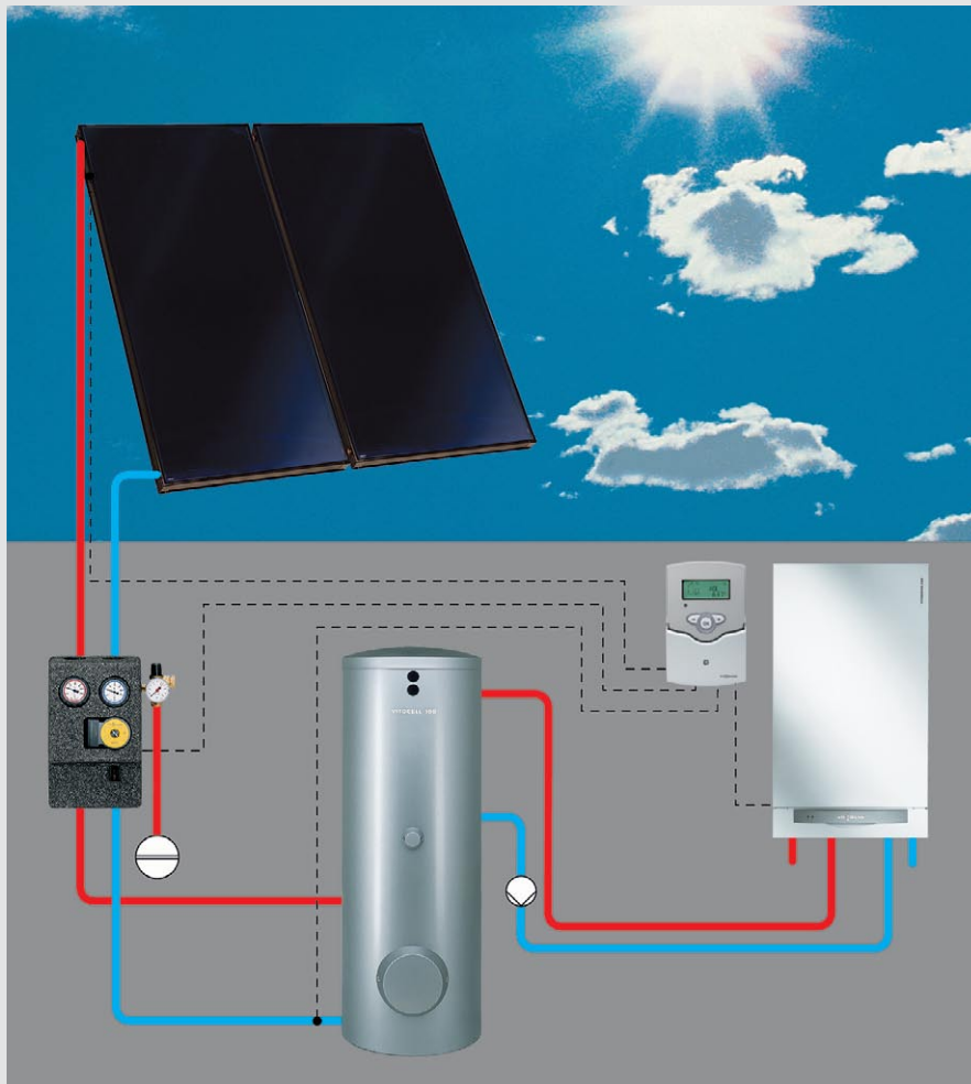
Rys. 50: Kocioł grzewczy, bivalentny pojemnościowy podgrzewacz ciepłej wody użytkowej, instalacja solarna i regulator w domu niskoenergetycznym
