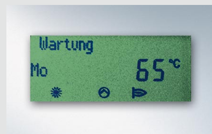
Rys. 77: Na wyświetlaczu ukazuje się komunikat przypominający użytkownikowi o konieczności przeprowadzenia konserwacji
